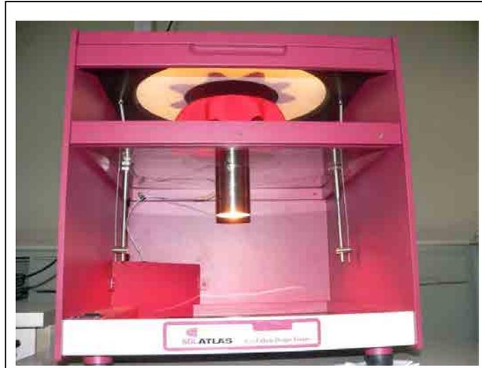
Figura 14-1.- Vista inferior de la versión actual del drapómetro Cusick comercializado por SDL Atlas. Fuente: Laboratorio de Física textil del Departamento de Ingeniería textil i papelera de la Universitat Politècnica de Catalunya
