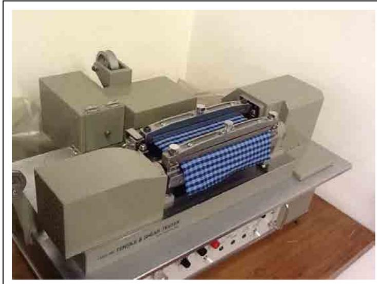
Figura 33-2. Unidad de medida de la tracción y cizalladura del equipo KES-F del Laboratorio de física textil de la Universidade do Minho en Guimarães (Portugal)
