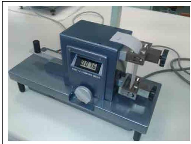
Figura 23-2. Equipo FAST-3 del Laboratorio de física textil. Departamento de Ingeniería textil y papelera. Universitat Politècnica de Catalunya.
