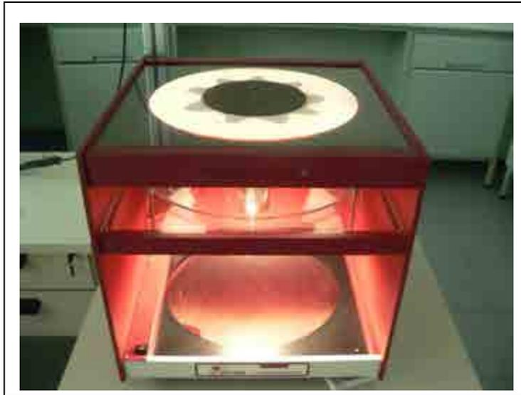
Figura 13-1.- Vista superior de la versión actual del drapómetro Cusick comercializado por SDL Atlas. Fuente: Laboratorio de física textil del Departamento de Ingeniería textil i papeleria de la Universitat Politècnica de Catalunya.
