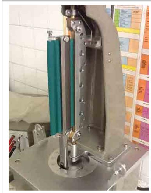
Figura 34-2. Unidad de medida de la flexión en el equipo KES-F del Laboratorio de parametría física textil. Instituto de Investigación Textil y de Cooperación Industrial de Terrassa. Universitat Politècnica de Catalunya
