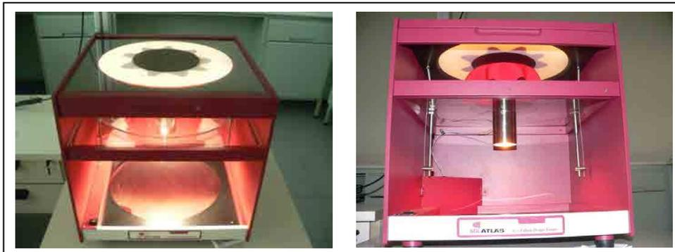
Figura 3-2. Modelo actual del Drapómetro desarrollado por Cusick. (Foto: Departamento de Ingeniería textil y papelera de la UPC).
