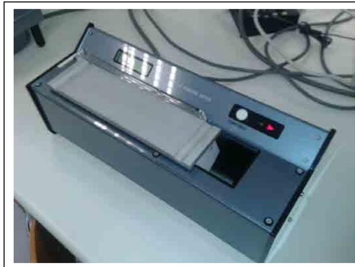
Figura 20-2. Equipo FAST-2 del Laboratorio de física textil. Departamento de Ingeniería textil y papelera. Universitat Politècnica de Catalunya.
