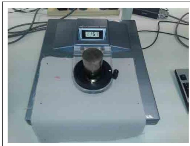
Figura 18-2. Equipo FAST-1 del Laboratorio de física textil. Departamento de Ingeniería textil y papelera. Universitat Politècnica de Catalunya.
