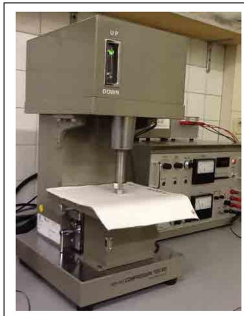
Figura 39-2. Unidad de medida del grosor en el equipo KES-F del Laboratorio de parametría física textil. Instituto de Investigación Textil y Cooperación Industrial de Terrassa. Universitat Politècnica de Catalunya
