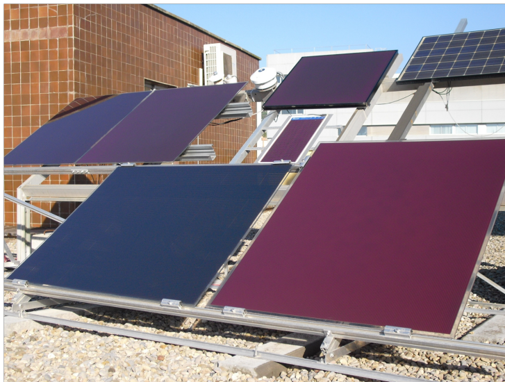
Figura 3.1: Sistema experimental para la caracterización de módulos fotovoltaicos en condiciones reales de operación
