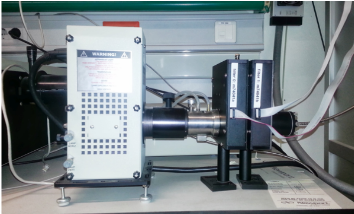
(a) Sistema de iluminación: simulador solar y filtros motorizados.
