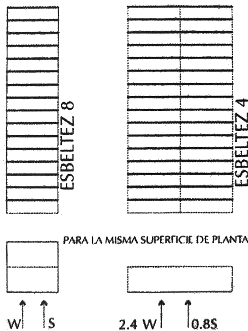
Figura 4.4-5. Influencia de las fachadas y la esbeltez frente a acciones del viento y sísmica. Valores de las cargas en Granada para una velocidad del viento de 120Km/h. (Imagen tomada de [Cobrerros Vime 2002, 22]).
