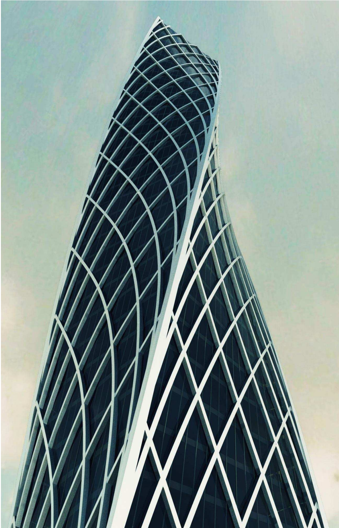
Figura 5.6-30. Propuesta de geometría de torre torsionada en base a la geometría optimizada propuesta. (Imagen propia).
