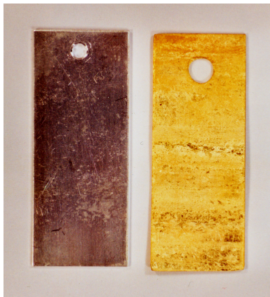
Figura 28. Láminas de plata y oro ( 21.1 \text{ cm}^2 ) empleadas en el estudio cinético
