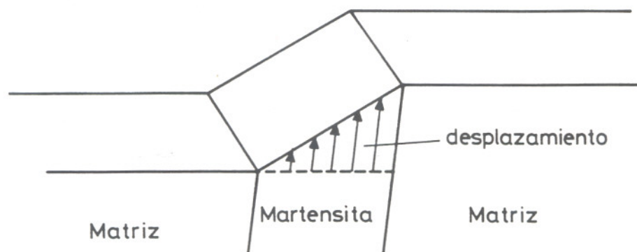
Figura 2.1: Aspecto macroscópico esquemático de la formación de una "placa" de martensita.
