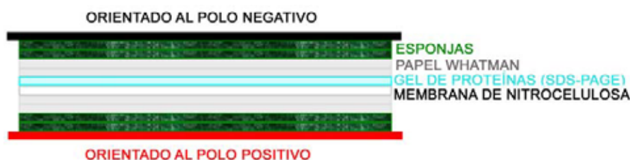
Figura M7. Componentes y orden de colocación durante el montaje del sándwich para la transferencia de las proteínas separadas en un gel de SDS-PAGE a una membrana de nitrocelulosa.
