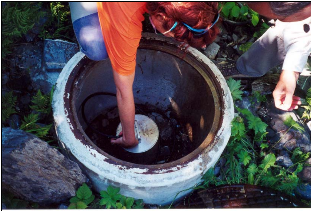
Figura 4-12. Instalación del sensor sísmico del emplazamiento C en Vallée de La Sionne. Fotografía realizada por Emma Suriñach Cornet
