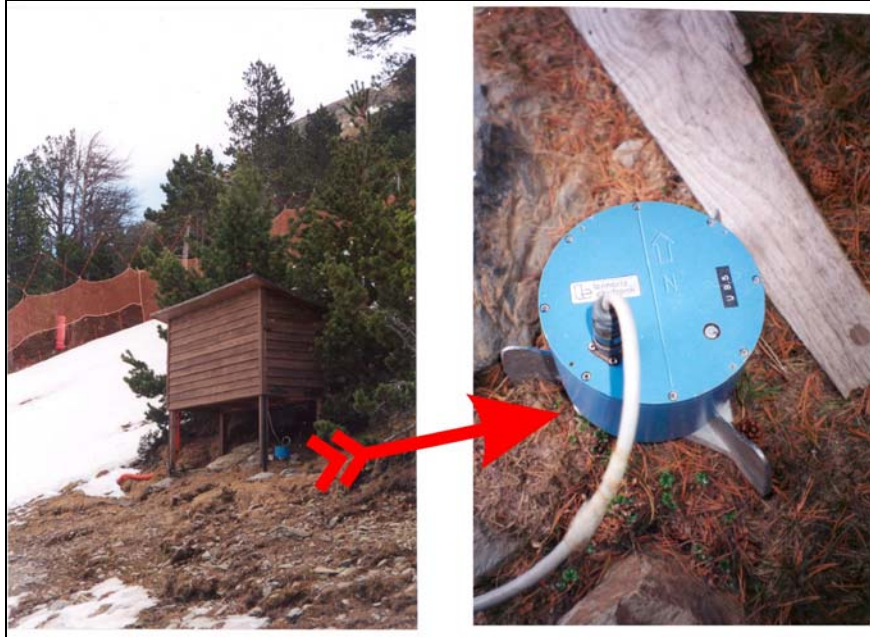
Figura 4-7. Fotografía de la caseta (izquierda) donde se dejó instalada la estación en las campañas del 1997-2002 y del sensor (derecha) instalado bajo la caseta de madera. Fotografías realizadas por Glòria Furdada Bellavista.
