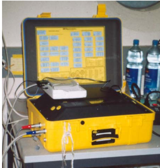
Figura 5-4. Fotografía de la estación Orion de la casa Nanometrics instalada en el centro de control de Vallée de La Sionne. Sobre la estación de registro se puede ver la caja blanca en la que se colocaba el módem.
