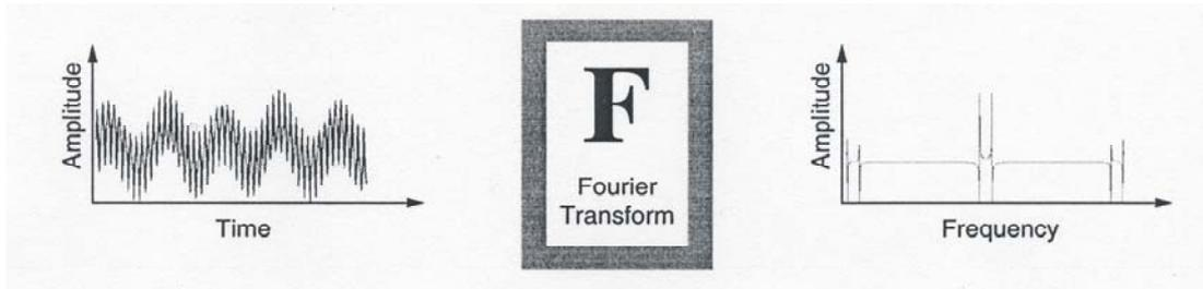
Fig. 25.1. Diagrama esquemático sobre cómo actúa la Transformación de Fourier en una señal (extraído de Mathworks, 1997).
