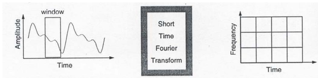
Fig. 25.2. Diagrama esquemático sobre cómo actúa el STFT en una señal (extraído de Mathworks, 1997).
