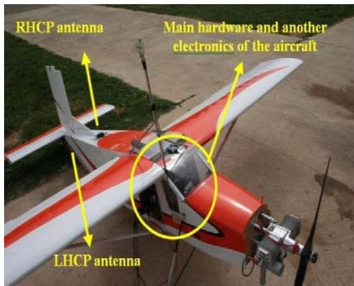
(a) Avión con el sistema GNSS-R
