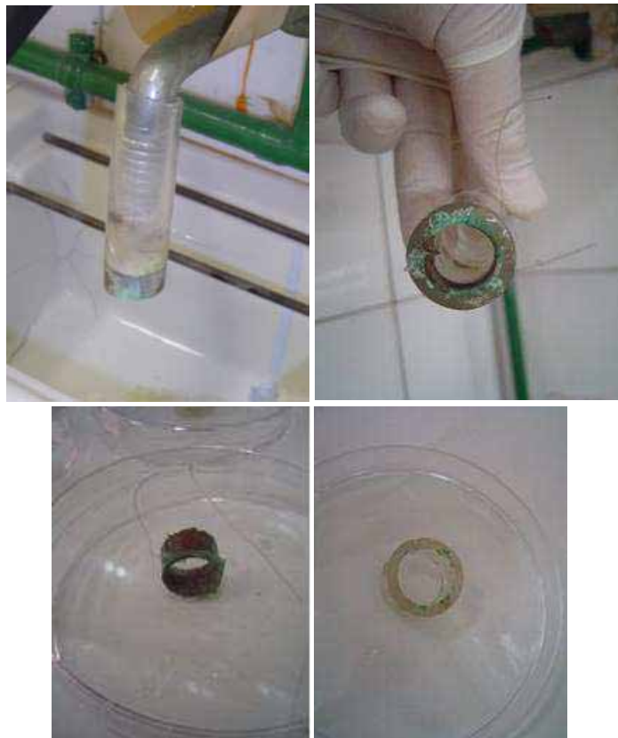
Fig. 4.30. Les imatges mostren com es va adaptar un tros de canonada de coure en una aixeta mitjançant un tub de tefló. El tub i l'anella es varen separar per observar-los individualment.
