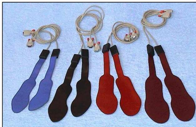
*Figura 2.14- Juego de plantillas instrumentadas.*
