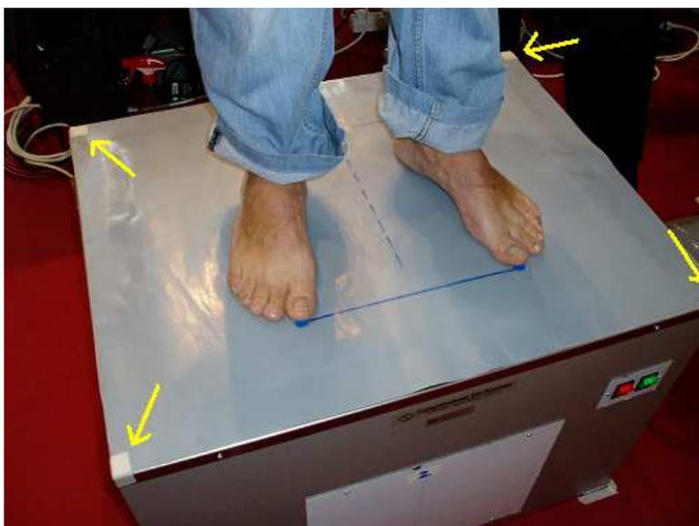
*Figura 3.13- Fijaciones Tapiz de la Plataforma optométrica*
