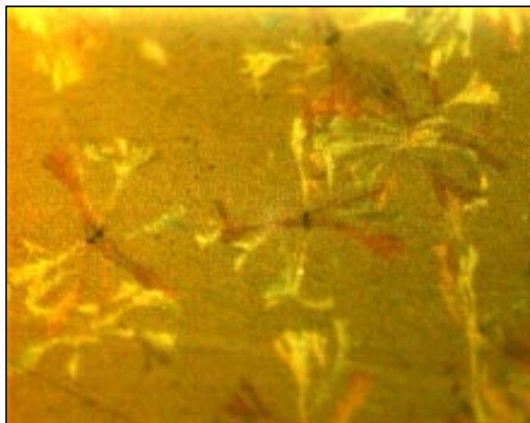
Fig. 6.46 Imatge de microscòpia òptica amb llum polaritzada d'una capa de F_2 -PDT-EDT-TTF, T_s = 300 K.
