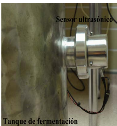
Figura 5.16 Sensores ultrasónicos acoplados a tanques de fermentación de acero inoxidable y 100 l de capacidad.
