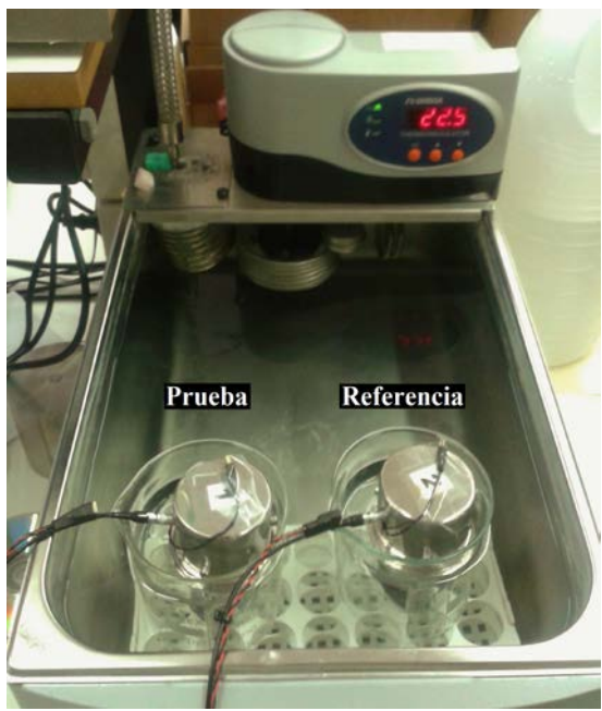
Figura 6.10 Montaje Prueba-Referencia para aplicar compensaciones a las medidas de velocidad en mezclas que involucren alguna concentración fija de etanol.
