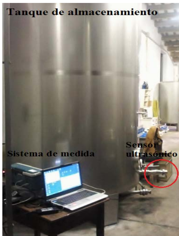
Figura 5.26 Montaje realizado para monitorizar la FML del vino elaborado en la bodega Torre del Veguer.
