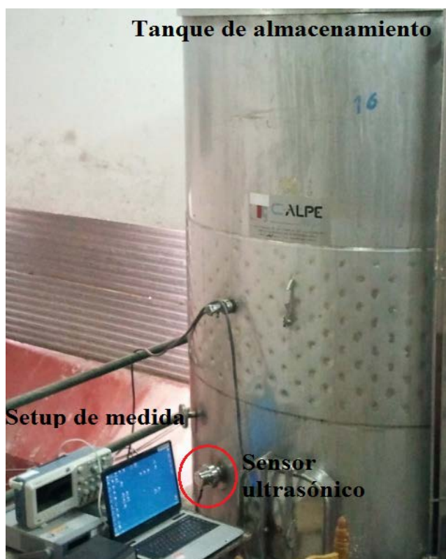
Figura 5.25 Montaje realizado para monitorizar la FML del vino elaborado en la bodega Vega de Ribes.
