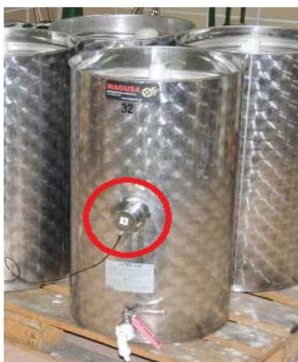
Figura 3.7 Imagen de un tanque de fermentación de vino tinto con capacidad para 100 l. Se señala en rojo el sensor ultrasónico diseñado que es acoplado a través de un agujero roscado DN50.
