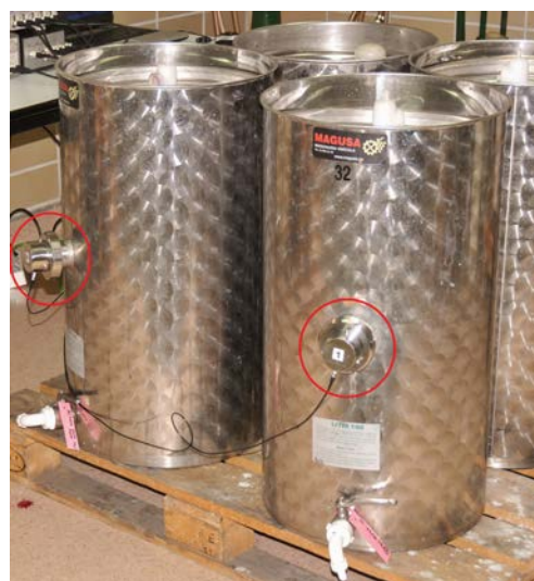
Figura 5.16 Sensores ultrasónicos acoplados a tanques de fermentación de acero inoxidable y 100 l de capacidad.
