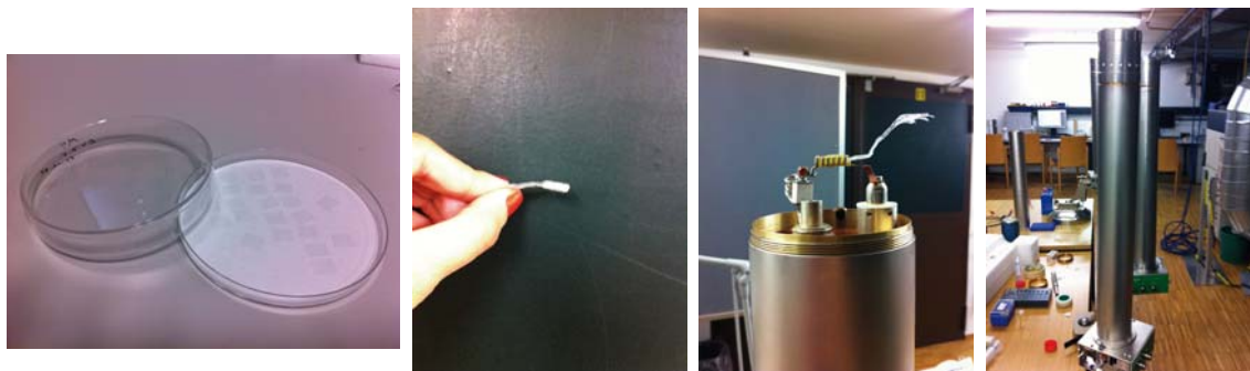
Figura 11: Preparació de mostres per RMN de fases condensades. D'esquerra a dreta: (1) Preparació de la mostra, (2) embolcall de la mostra, (3) les mostres es col·loquen a la sonda de bobina plana i (4) la sonda s'introdueix en l'espectròmetre de RMN per efectuar les mesures.
