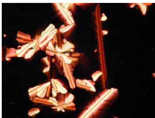
Figura 4.2. Textura de la mesofase de la porfirina Cu-10 a 160 °C, refredant des del líquid isotròpic.
