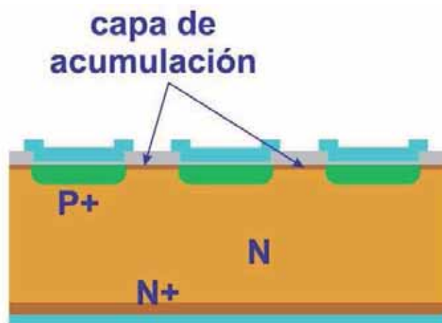
Figura 1.7: Esquema de un detector fabricado en tecnología P-sobre-N .
