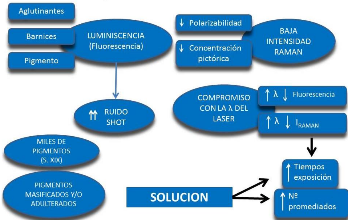
Figura 17. Diagrama sobre algunos problemas fundamentales en el análisis de pigmentos con espectroscopia Raman.
