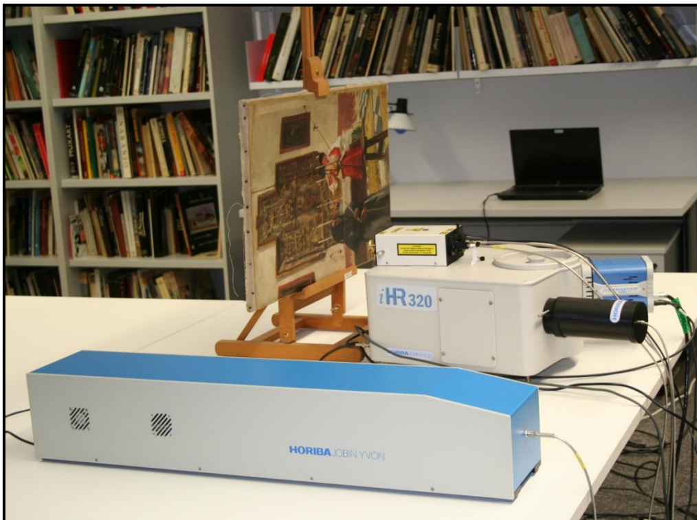
Figura 7. Fotografía del equipo de espectroscopia Raman portátil con fibra óptica, modelo iHR320, de Jobin Yvon (Grupo Horiba).
