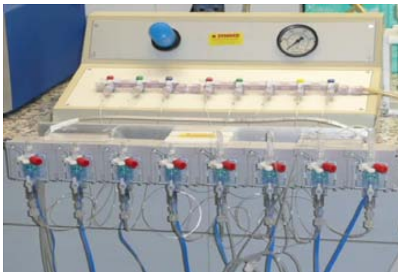
Figura 13. Sistema multicanal para el registro manométrico.
