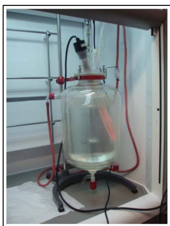
Figura 3.2 Fotografía del reactor de 10 L.
