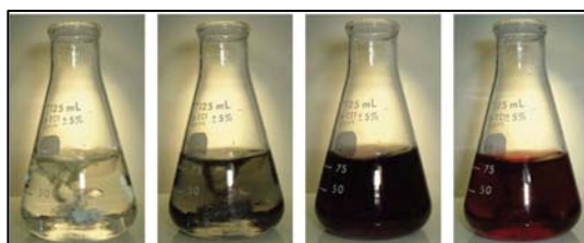
Figura 3.1 Imagen donde se observa la evolución del color de la solución durante la síntesis de AuNPs a una concentración final de 100 ppm.
