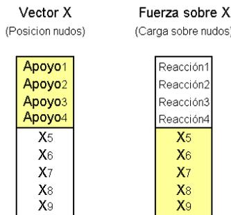
Figura 16: Esquema que muestra las partes de los vectores que son conocidas
