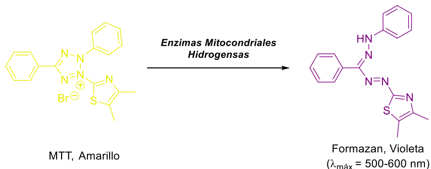
Figura 10.15. Transformación del reactivo MTT de color amarillo a Formazano mediante la acción de las enzimas mitocondriales deshidrogenasas que actúan en las células vivas.
