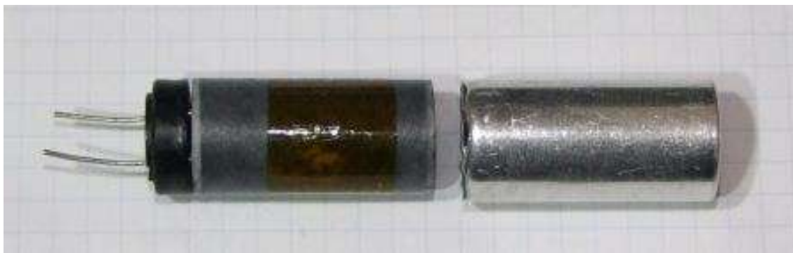
Figura 83. Extraient l'encapsulament d'alumini es pot observar l'estructura interna del supercondensador.
