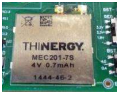
Figura 54. Bateria flexible THINERGY que proporciona 0,7mAh
