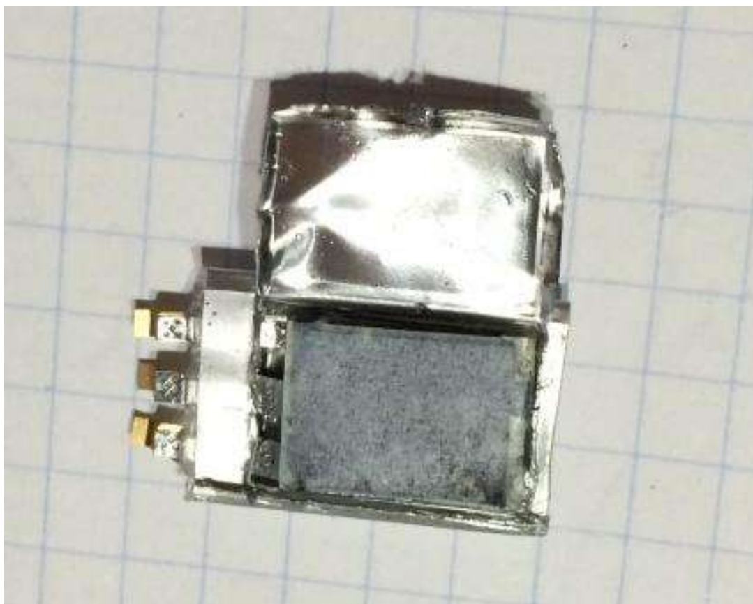
Figura 91. Supercondensador comercial de 150mF / 5V.
