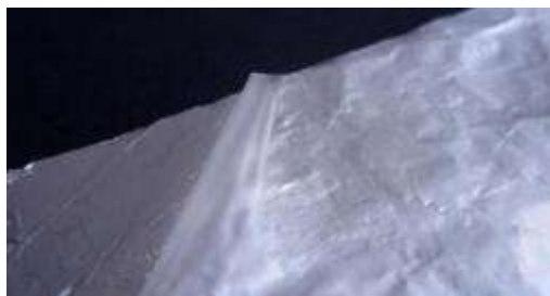
Figures 27 i 28. Dipòsit de PVDF fent servir bar-coater sobre lamines d'alumini.
