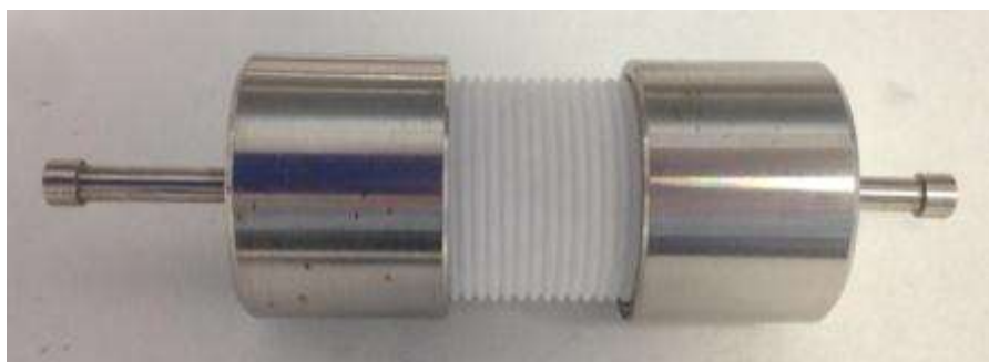
Figura 120. Cel·la preparada per fer les mesures a dos elèctrodes.
