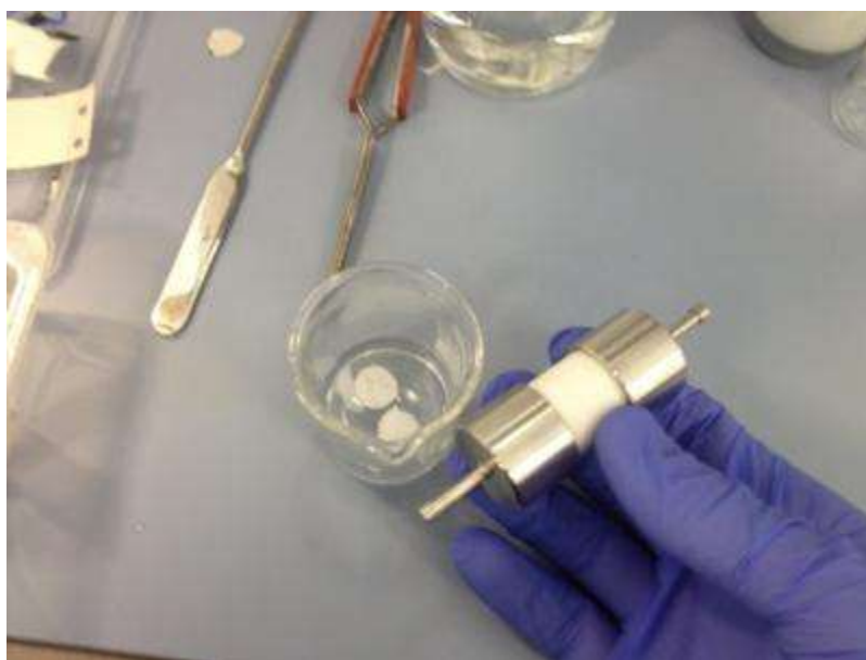
Figura 120. Cel·la preparada per fer les mesures a dos elèctrodes.
