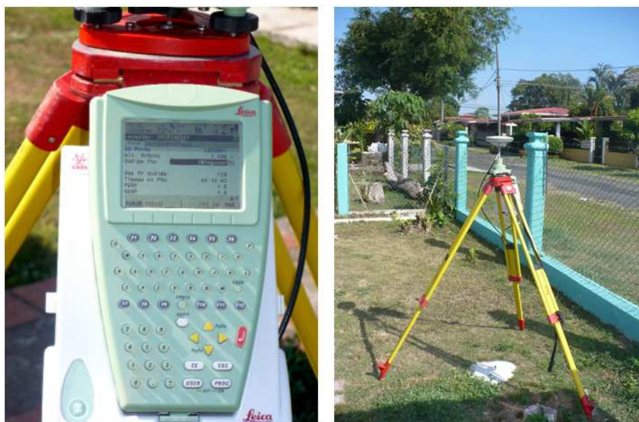
Figura 4.16. Estación GPS Leica 1200GG utilizada para georeferenciar las estaciones gravimétricas medidas en el sector de Las Tablas (izquierda) y posición de la estación base para el cálculo diferencial (derecha).
