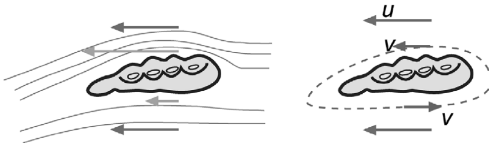
Fig.3.1.6. Línies de flux al voltant de la mà. Podem diferenciar dos tipus de circulacions: la del flux que es desplaça u , i la del vòrtex generat v , extret de Toussaint and Truijens (2005)
