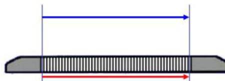
Figura 3.4: Esquema de una sección de un colimador paralelo. El sistema de detección está localizado debajo del colimador. La flecha roja corresponde a la imagen del objeto representado con la flecha azul.
