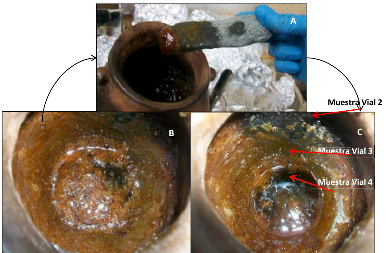
Fig. 7.9. Proceso de extracción de la cera de abeja (sobrenadante) con el alisador y visualización del muestreo realizado.
