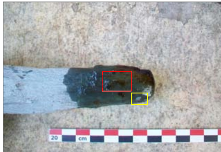
Fig. 7.17. Aspecto de la superficie del alisador durante su combustión.
