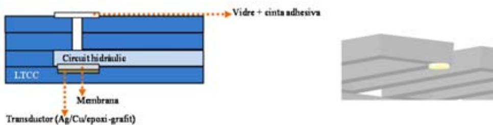
Figura 5.51. Esquerra: representació gràfica de la configuració de cel·la tipus III. Dreta: configuració del circuit hidràulic encabit dintre del microsistema LTCC.
