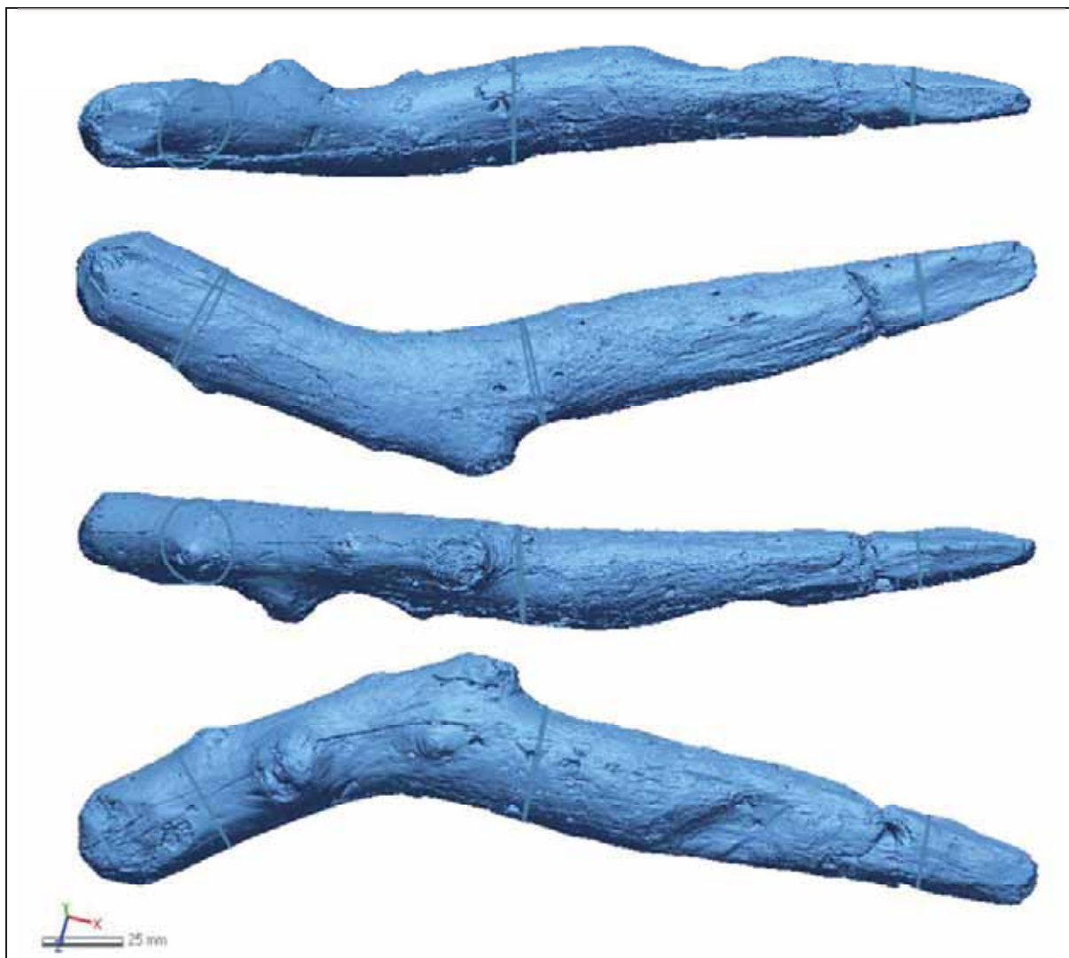
En el pal apuntat arqueològic D/98 GH-100/11, elaborat a partir d'un tronc sencer de rosàcia, no s'hi han identificat marques d'esberlat.
