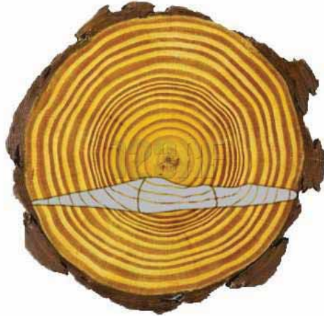
Figura 34 - Situació original de la pala en el tronc de roure seguint l'orientació dels trets anatòmics.
