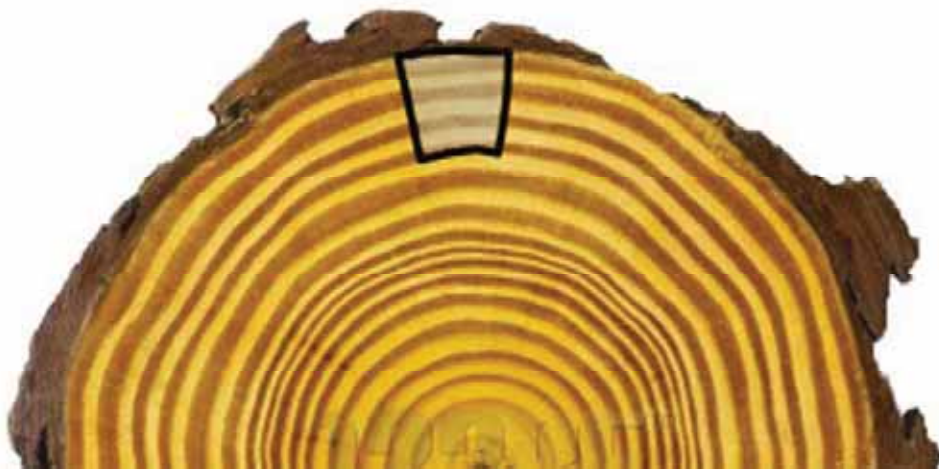
Figura 46 - Situació original del coordinat 4476 en el tronc seguint l'orientació dels trets anatòmics
