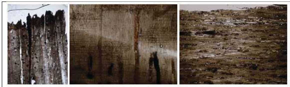
Figura 350 - Imatges dels plans d'observació anatòmica: pla transversal (esquerra), pla longitudinal radial (centre), i pla longitudinal tangencial (dreta).
