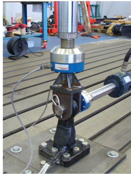
Figura 10.5: Detall de l'utilatge d'aplicació de la força en l'enganxall d'anella
