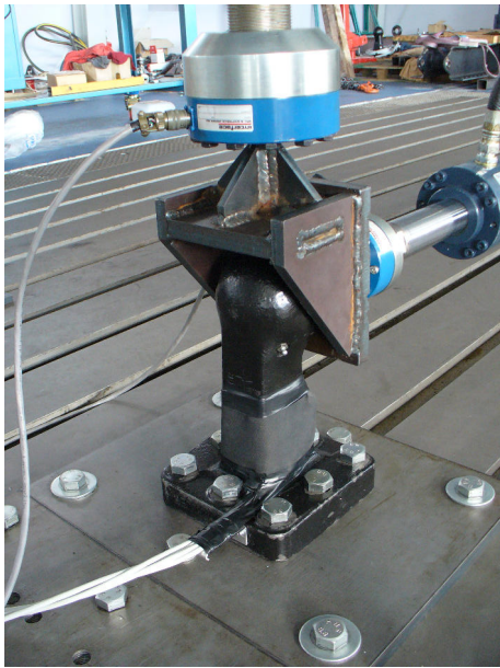
Figura 10.4: Detall de l'utilatge d'aplicació de la força en els enganxalls de bola
