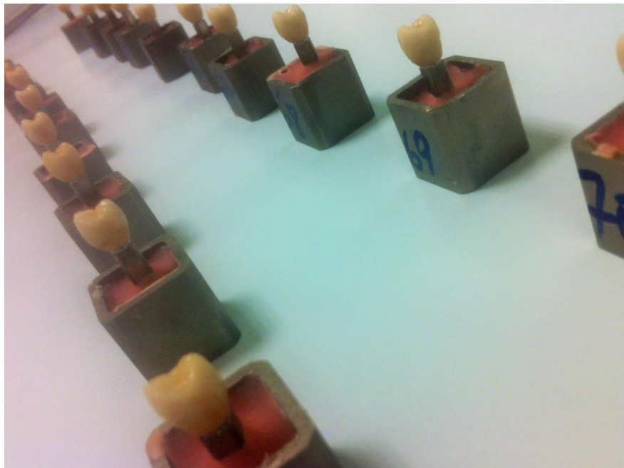
Figura 3. Coronas elaboradas mediante la técnica de fresado cementadas sobre sus muñones y colocadas en sus respectivos cubiletes metálicos numerados
