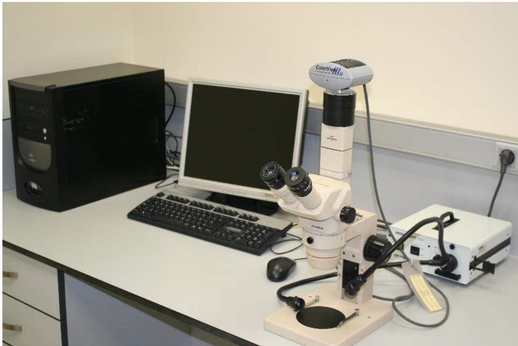
Figura 4. Estereomicroscopio conectado a la cámara fotográfica y al ordenador
