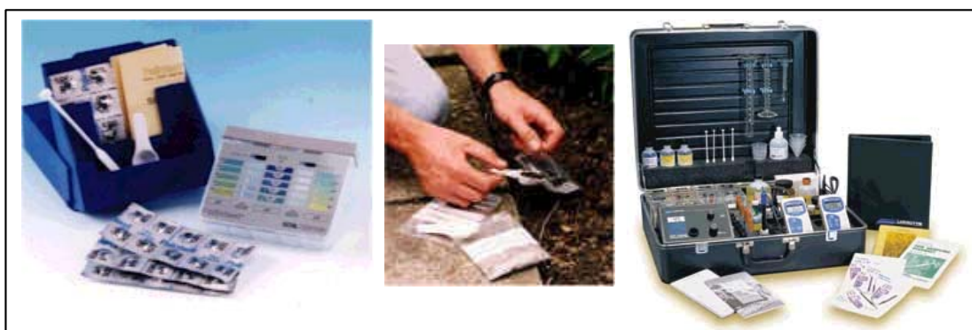
Figura 1.22: Amb l'ús de kits comercials es pot analitzar la mostra directament en el camp, mitjançant un test de comparació com el de l'esquerra o bé amb mètodes colorimètrics com el de la dreta.
