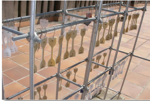
Figura.2.42. Ensayo de degradación a la intemperie con disposición de las muestras de material compuesto en estructura metálica.
