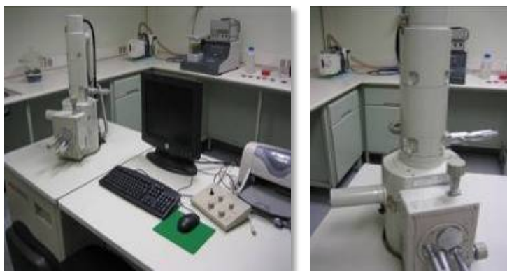
Figura 2.36. Microscopio electrónico de barrido JEOL 5610
