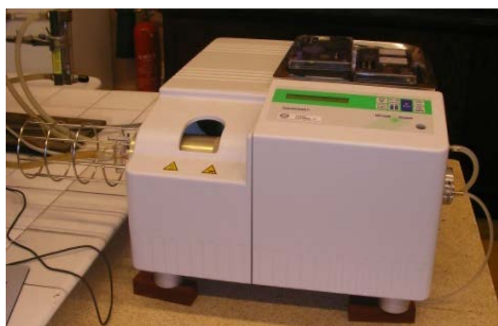
Figura 2.40. Equipo de análisis térmico - TGA/SDTA850 e .
