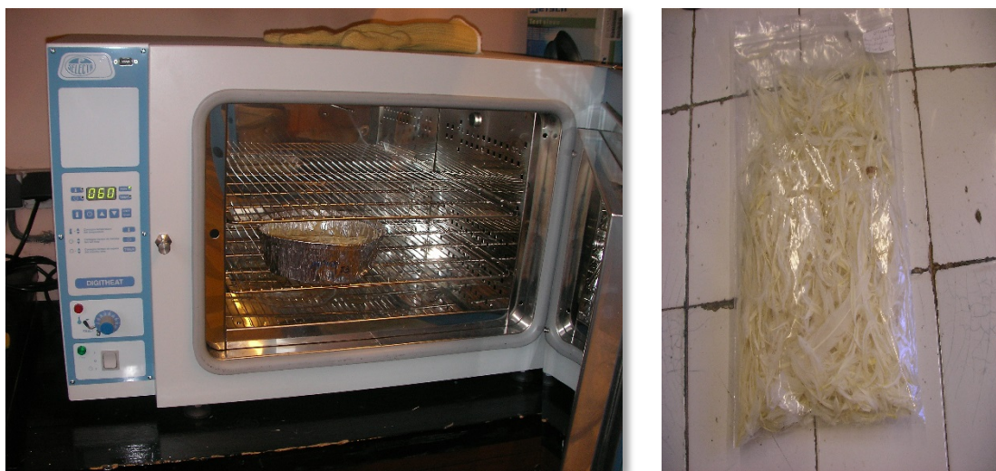
Figura 2.26. Proceso de secado de las plumas en la estufa.
