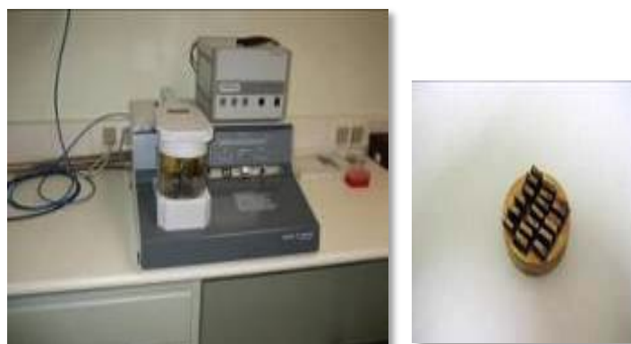
Figura 2.37. (a) La máquina de recubrimientos (sputtering) (b) Portamuestras del SEM.
