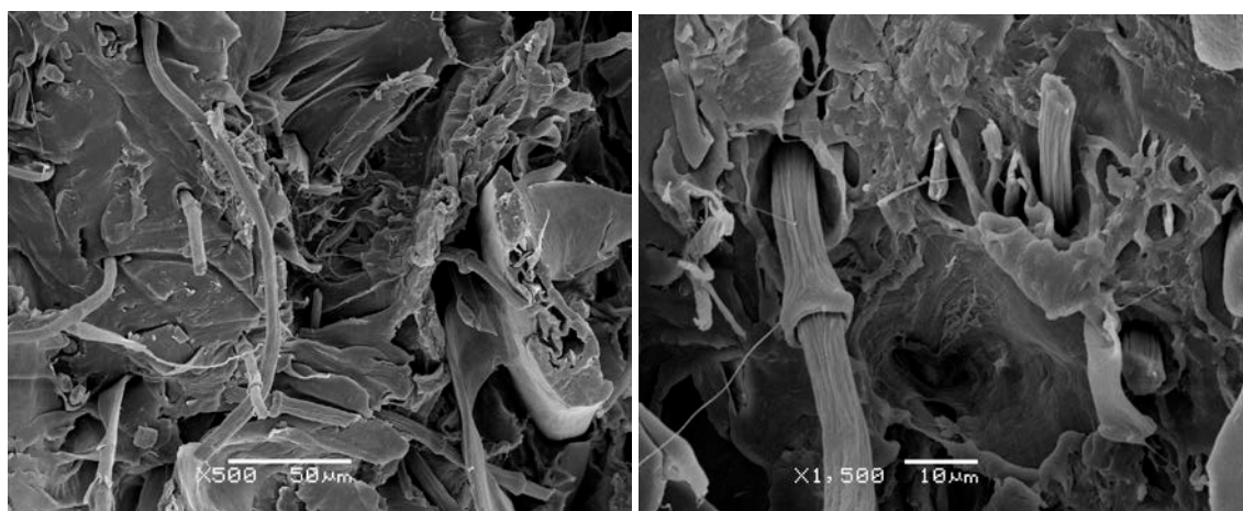
Figura 3.34. Microfotografías SEM de la superficie de fractura de las probetas de EVA/FQ.
