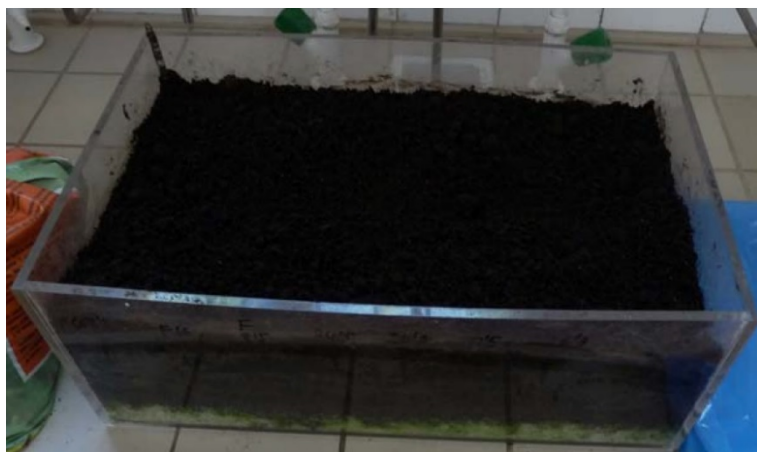
Figura 2.41. El recipiente donde se lleva a cabo la prueba de biodegradabilidad Soil Burial Test
