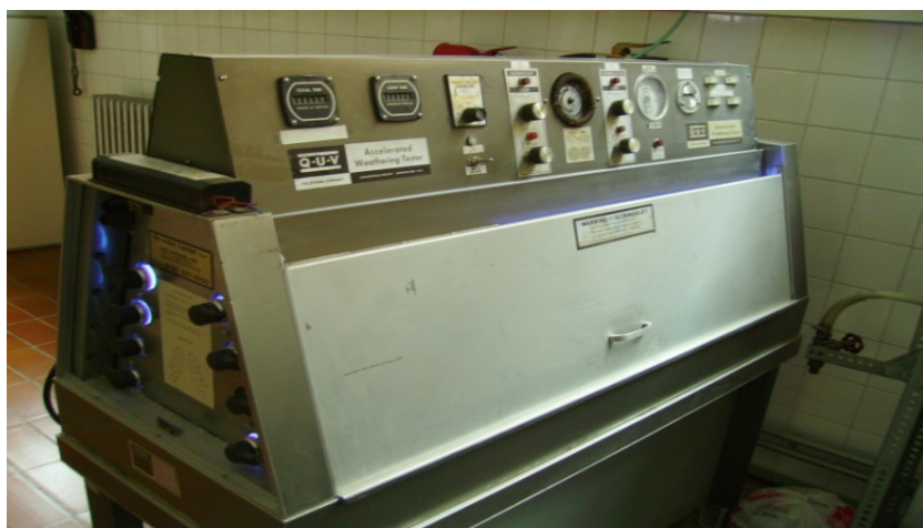
Figura.2.43. Cámara de envejecimiento acelerado UV.
