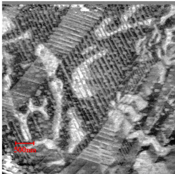
Fig. 1.7 Configuración de los dominios dentro de un grano de PLT. Imagen obtenida por piezorespuesta (PFM) en el Grupo de Cerámicas Ferroeléctricas, UFSCar, Brasil.
