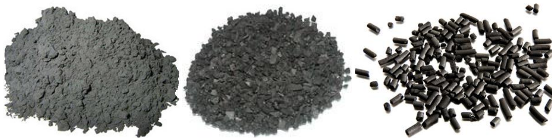
Figura 3. 5. Classes de carbó actiu en funció de la seva mida de partícula: pols (esquerra), trossejat (centre) i conformat (dreta) (Siamnathan, 2011).
