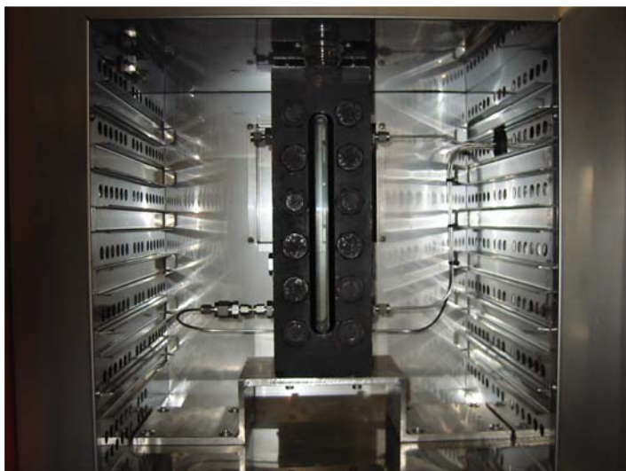
Figura A8: Imatge frontal de la cel·la de volum variable.
