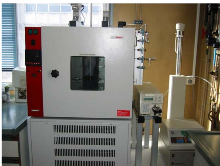
Figura A9. Imatge completa de l'equip on es visualitza la cambra de fred/calor que conté la cel·la (esquerra), la bomba de líquids (centre sobre estructura) i la bomba de CO_2 (dreta)
