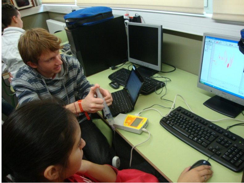
Figura 10. Alumnes fent servir un sensor de pressió i una xeringa per a estudiar la relació pressió-volum d'un gas.
