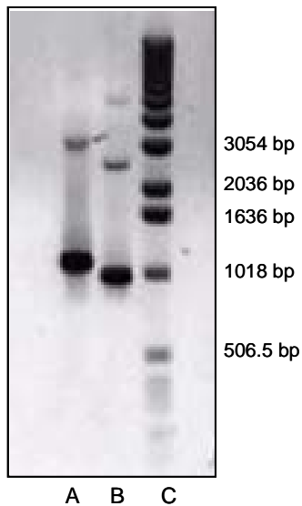
Figura 4.11. Gel de agarosa al 1 %. (A) Banda de 1.1 Kb del gen fda amplificado por PCR usando los oligos 5fda y 3fda (30 ciclos; T_m = 50\text{ }^{\circ}\text{C} ). (B) Banda de 1.0 Kb (B) del gen lacD amplificado por PCR usando los oligos 5lacD y 3lacD (30 ciclos; T_m = 52\text{ }^{\circ}\text{C} )
