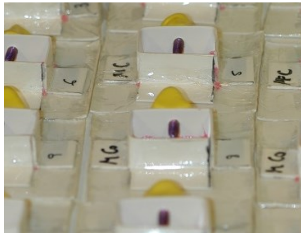
Fig. 5.32. Mostres abans de ser carregades amb la resina fotoelàstica. Es pot observar cadascun dels motlles amb els implants en el seu interior i com, mitjançant un petit bloc de silicona agafant el pilar cimentable, els implants queden fixats en el seu interior.
