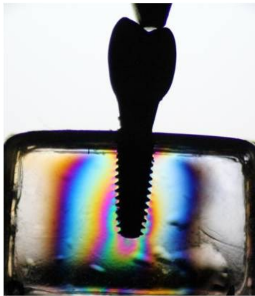
Fig. 6.23. Disposició de la càrrega de la proveta MET 300 N
