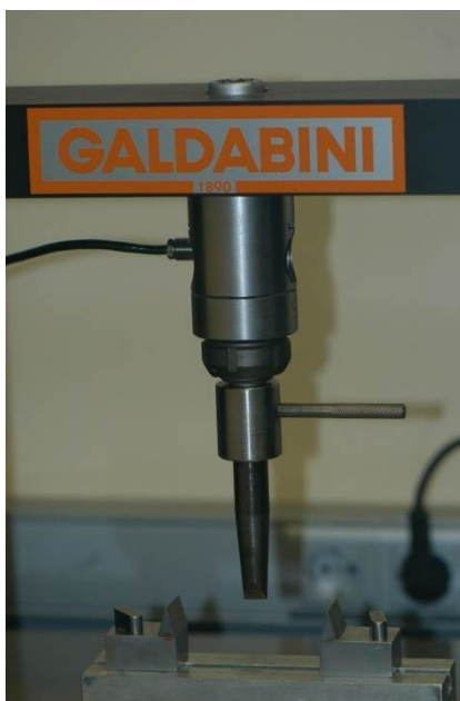
Fig. 5.20. Visió parcial de la base i el braç de la màquina d'assaigs universal Galdabini Quasar 5
