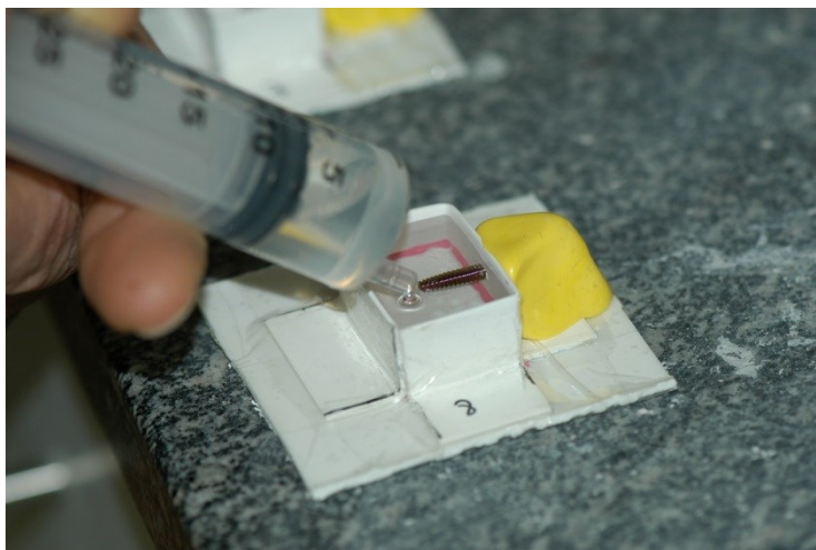
Fig. 5.37. Fotografia on s'observa omplir un dels motlles de les mostres amb la xeringa de plàstic.
