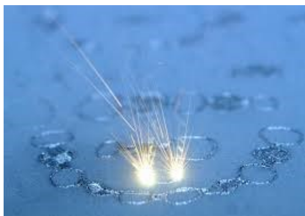
Fig. 5.28. Sinterització per làser de pols de Cr-Co. (www.renishaw.com)
