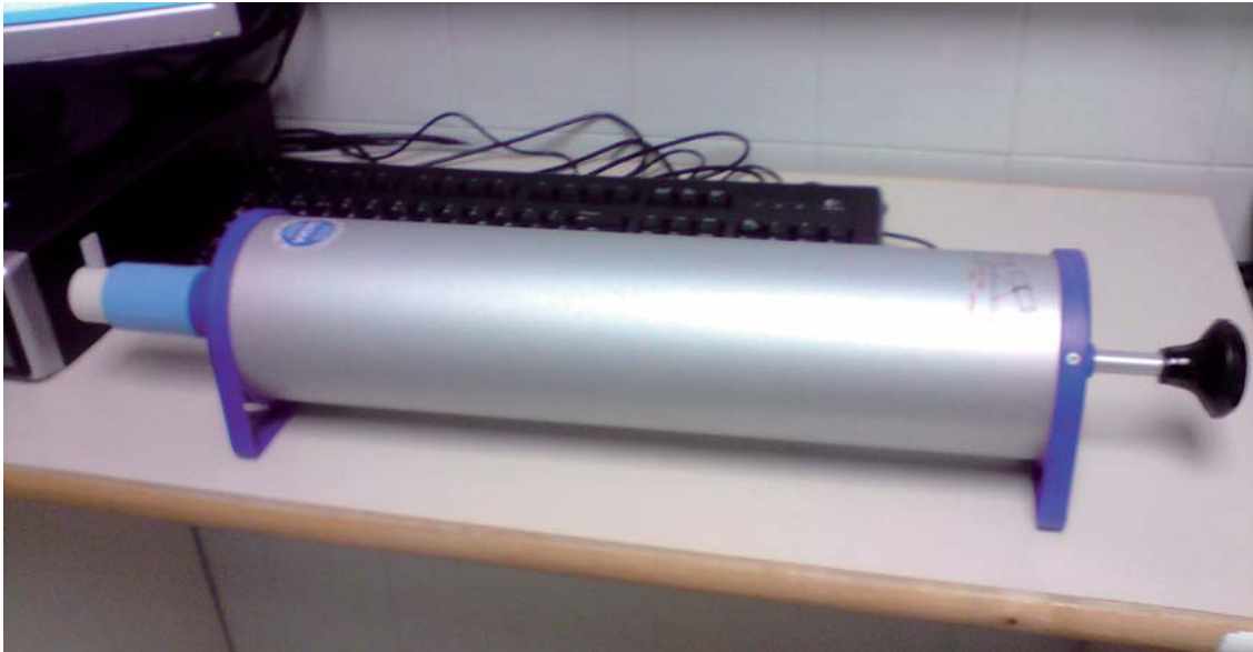
Figura 3.2. Jeringa de 3 L de calibración.
