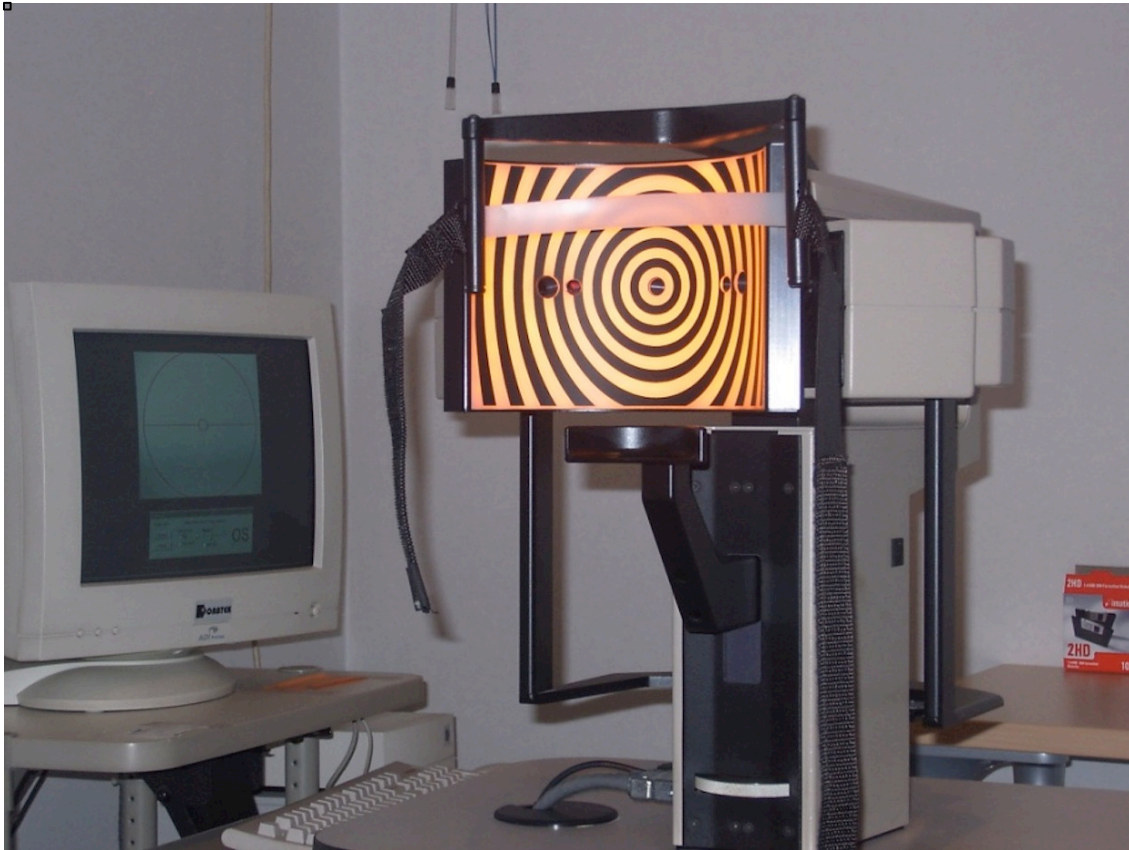
Fig. 11.- Topógrafo Orbiscan IIz basado en anillo de Plácido y análisis de múltiples hendiduras.
