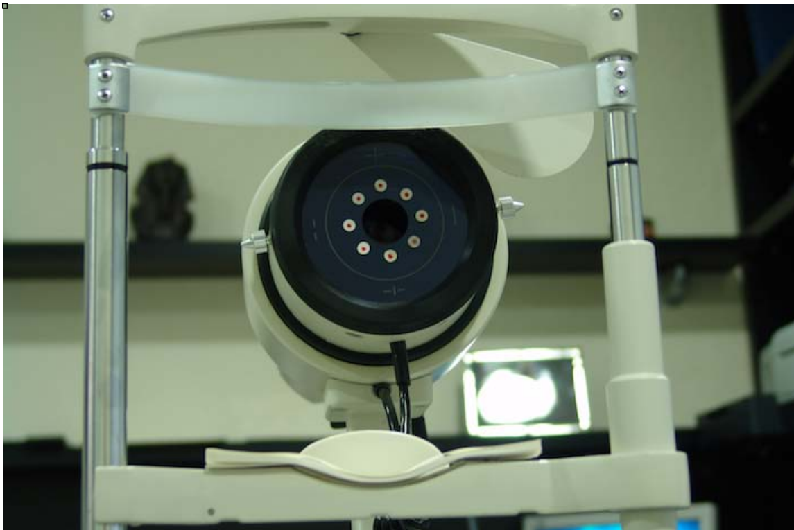
Fig. 9.- Queratómetro de Topcon, basado en el modelo inicial de Bausch and Lomb. Vista del paciente.
