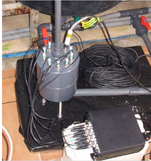
Figura 3.8 Fotografia del sistema de mesura de 8 canals, en el seu emplaçament en les instal·lacions de l'IRTA, amb els vuit elèctrodes usats a la primera aproximació i la sonda de temperatura dins la cel·la de mesura.
