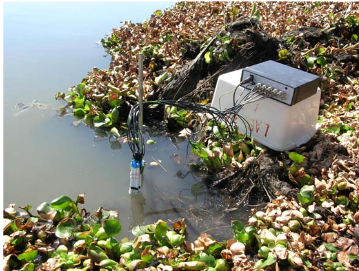
Figura 3.9 Fotografia del sistema de mesura de 12 canals durant el seguiment a la presa IR.
