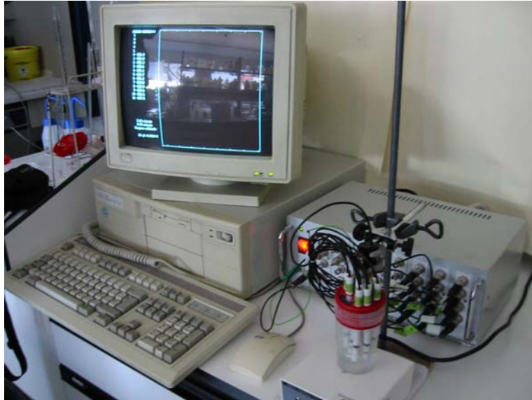
Figura 3.7 Fotografia del sistema de mesura de 32 canals, la cel·la de mesura i l'ordinador personal.
