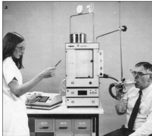
Figura 1.17. Espiròmetre d'aigua Godart, amb un mòdul electrònic.
