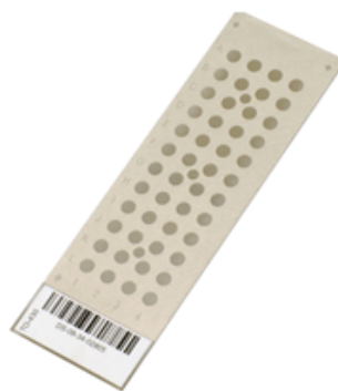
Figura 9. Imagen de la placa y los pocillos donde se depositan las muestra para su identificación mediante el sistema VITEK-MS.
