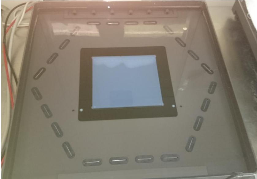
Figura 13. Imagen del gel en la cubeta de electroforesis sumergido en TBE 0,5 X.
