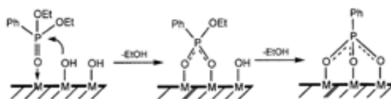
Figura 1.23: Representación esquemática de la reacción de \text{PhPO}_3\text{Et}_2 en una superficie de óxido metálico para formar la especie tridentada \text{PhP}(\text{O}_3\text{Ti})_3 .
