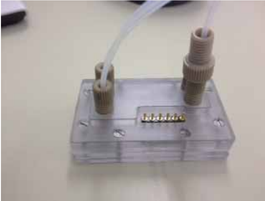
Figura 4.16: Un dels primers prototips amb connexions hidràuliques roscades, placa interior i connector elèctric comercial estàndard.
