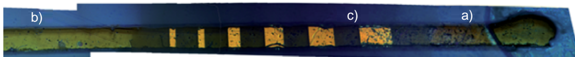
Figura 4.23: Composició de fotos de microscòpia del canal amb elèctrodes d'or: visió general. a) Detall de la sortida del canal. b) Canal després de cert ús. c) Elèctrode després de cert ús. (Vegeu les figures següents per a una explicació més detallada.)
