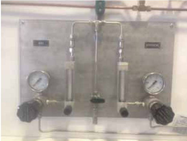
Figura 4.22: Sistema de control de gasos. El percentatge de saturació d'oxigen es controla mitjançant la barreja d'aire i nitrogen pur (mitjançant el cabal bombejat en ml/min). Així, ajustant els manòmetres corresponents, s'obtenen riqueses d'aire (amb l'oxigen corresponent) de 100, 66, 50, 33 i 0 per cent.
