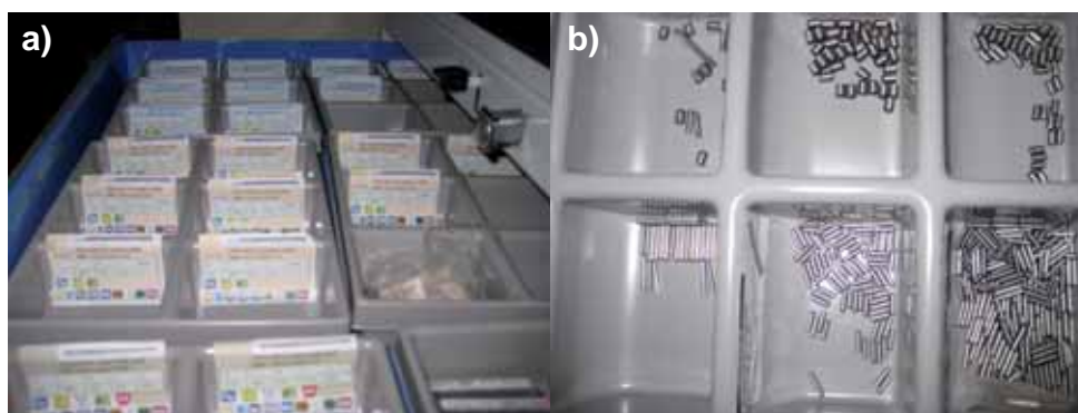
Figura 4.13: a) diferents tipus de capçals de fresa per adaptar-los a la feina a realitzar. b) agulles d'alineament de diferents gruixos i longituds.
