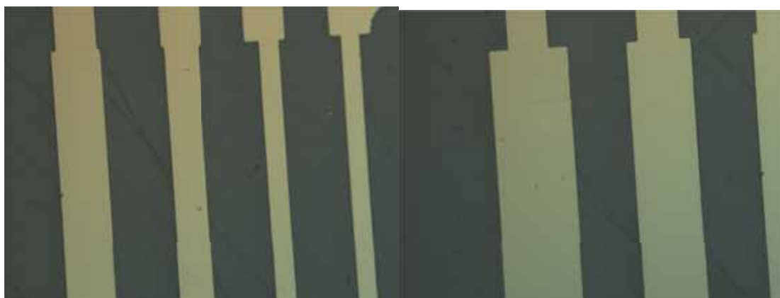
Figura 4.5. Fotos elèctrodes d'or (nous, abans d'usar). Vista elèctrodes (objectiu x5).
