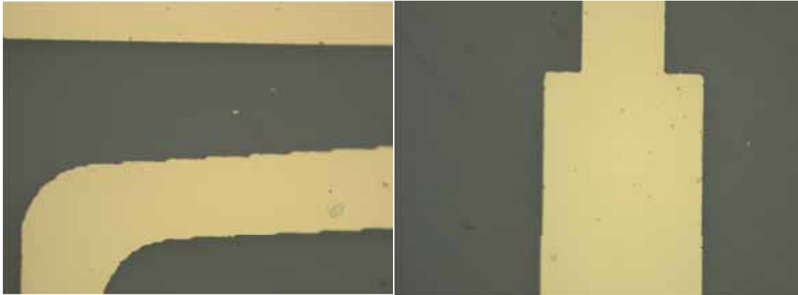
Figura 4.6. Detall (objectiu \times 10 ) d'un connector elèctric i de la unió a un elèctrode. El pixelat que es pot observar és degut a la qualitat d'impressió del fotolit amb el qual es van fer i no al procés de fabricació.
