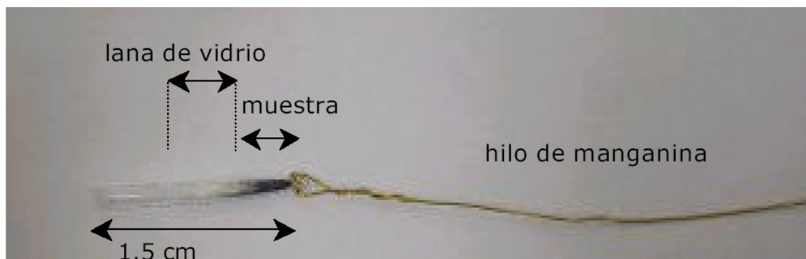
Figura 2.7: Portamuestras casero de vidrio para medir a altas temperaturas en el SQUID
