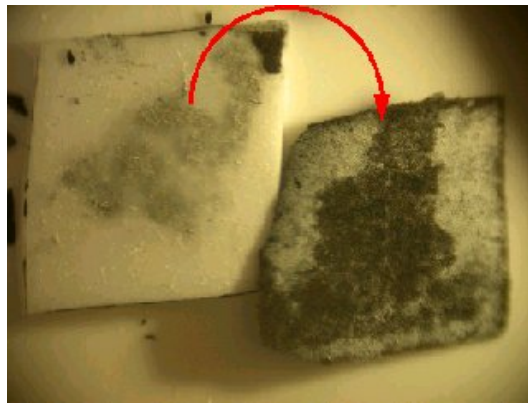
Figura 9.20: Capa de Sr_2FeMoO_6 sinterizada sobre YSZ y completamente desadherida
